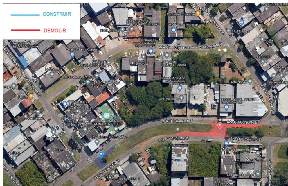
Figura 9.2 - Indicação das atividades relacionadas a demolição e construção de pavimento flexível nos retornos
